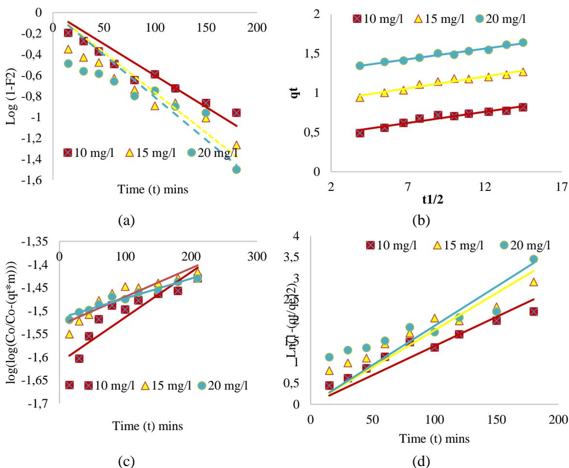
**Figure 7.** (a) Dumwald-Wagner diffusion model (b) Intraparticle diffusion (Weber Morris) (c) Banghams (d) Vermeulin diffusion model of the adsorption of BB on modified GAB
