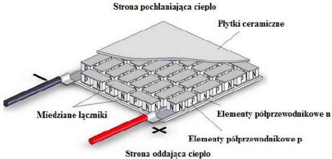
Rys. 1. Budowa i zasada działania modułu Peltiera
