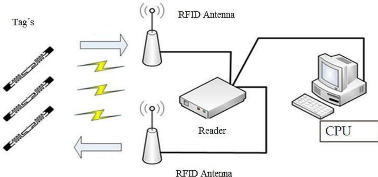
Figure 1. RFID System.
